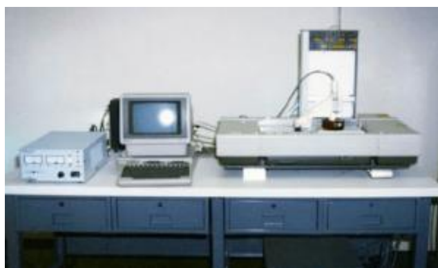
Figura 1 – Máquina de foto polimerização inventada por Charles Hull
